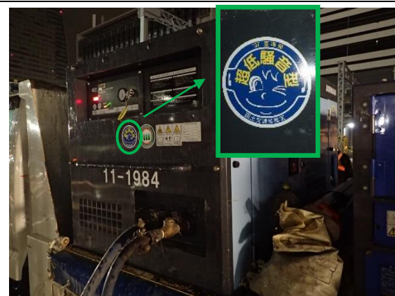
写真4-1-7-4 低騒音型建設機械の採用
